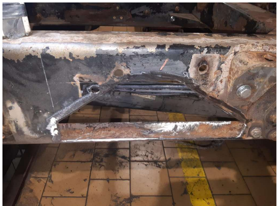
Detail opravy rámu vozidla
